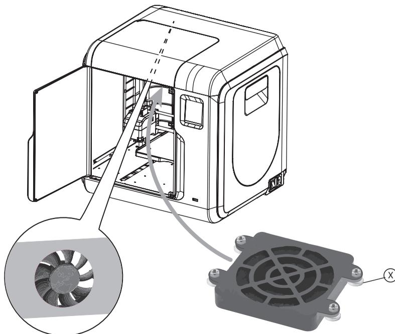
Der Drucker ist mit einem Lüfter ausgestattet, der sich im hinteren Teil des Druckers unter der oberen Abdeckung befindet. Er ist von einer Metallplatte eingefasst.
