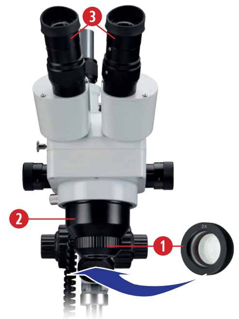
Fig. 13: Montaggio della lente aggiuntiva.
