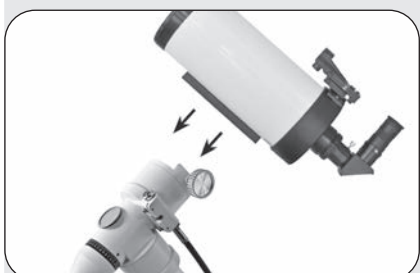
Afb. 8a: Invoegen van de optische buis met de prisma rail in de prisma railhouder en deze vastzetten.
