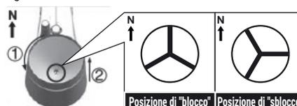
1. Ruotare il collettore di pioggia di 30° in senso antiorario.
