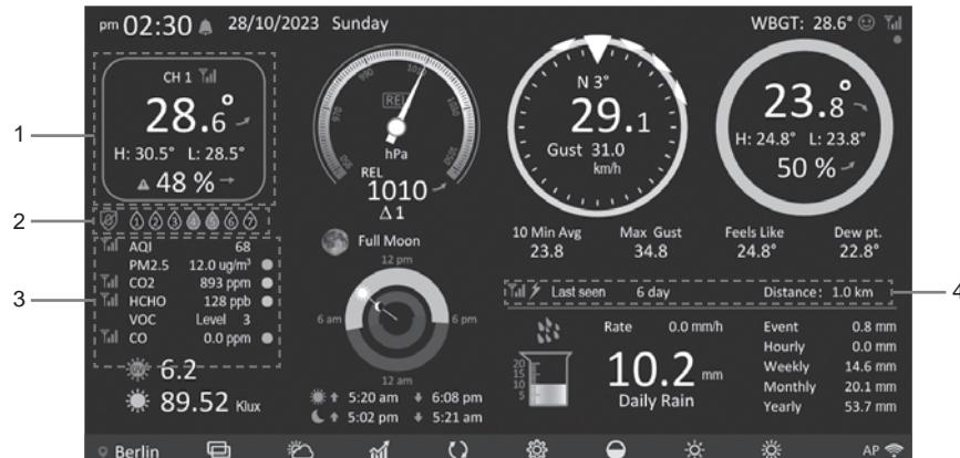
1. CH 1~7 Thermo-Hydro-Sensor(en): Sie können
