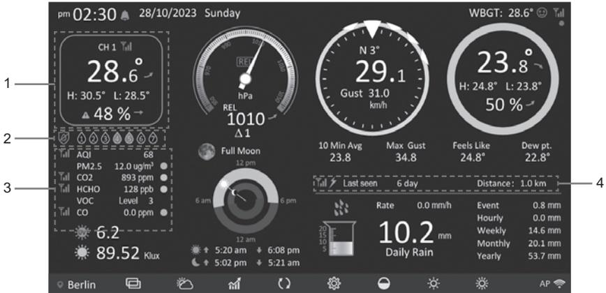
1. CH 1~7 Thermo-Hygro-Sensor(en): Sie können drücken, um zwischen den Innenraum- und Kanal-1-bis-7-Anzeigen von Temperatur und Luftfeuchtigkeit umzuschalten.
