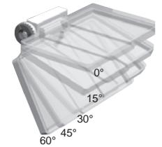
\*Sensoren, die auf der Südhalbkugel installiert sind, müssen ihre Solarmodule nach Norden ausrichten.
